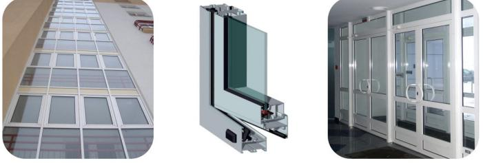
Все серии системы ALT C48 имеют одну базовую монтажную глубину для профиля рамы – 48 мм. Система обладает широкими возможностями применения различных типов заполнения в диапазоне от 4 до 34 мм: стекла, сэндвич-панелей, ДСП и прочего. За счет применения усиливающих профилей возможно изготовление конструкций большой высоты.
